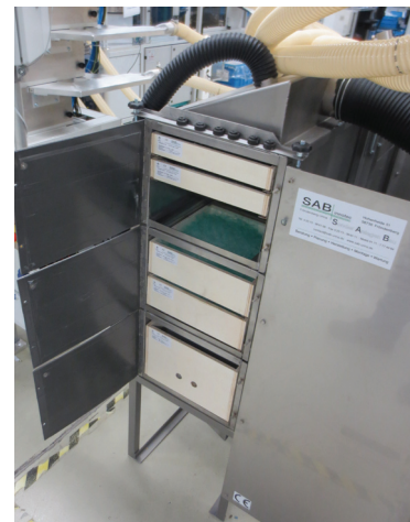
SL7008 Box Module für die Filtration von Kunststoffabbrand-Produkten. Bestehend aus Partikelfilter und Gasefilter (Aktivkohlefilter)
